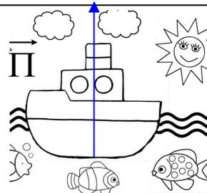
$\vec{\Pi}$  est verticale, vers le haut, est égale au poids du fluide déplacé soit  $m_{\text{fluide}} \cdot g = \rho_{\text{fluide}} \cdot V \cdot g$
