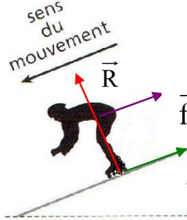
La réaction est normale (perpendiculaire au support) notée  $\vec{R}$  et vers le haut.
