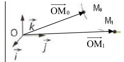
$\vec{OM}_0$  à la date  $t_0$  est différent de  $\vec{OM}_1$  à la date  $t_1$ . Il faut alors comprendre que les coordonnées,  $x_M$ ,  $y_M$  et  $z_M$  sont des fonctions du temps et non pas de simples variables.
